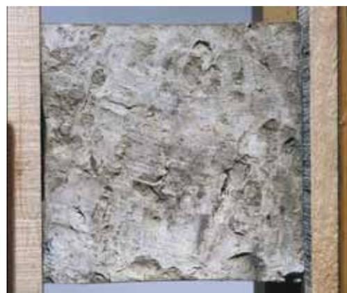
Fig. 18. Reverso del azulejo con las huellas del desbravado.
